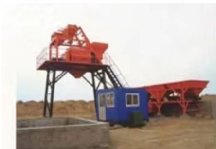
HZS50混凝土搅拌站
