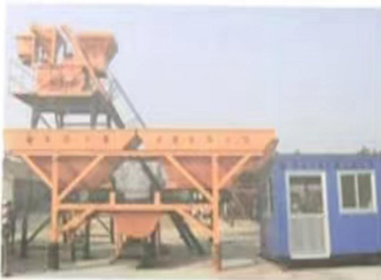
HZS25混凝土搅拌站
